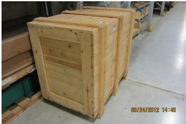
可接受的板条箱设计示例（实木结构）
