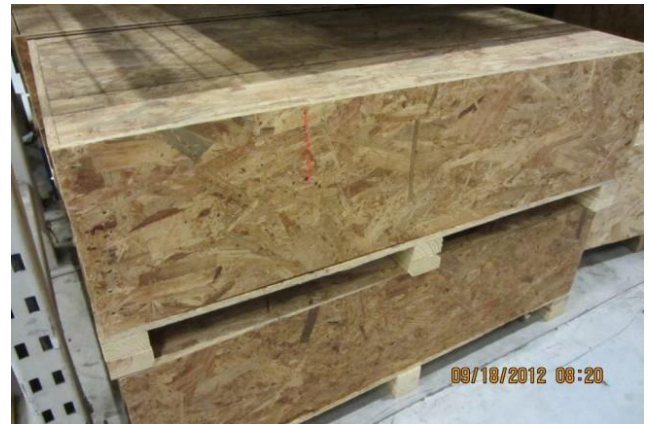
可接受的板条箱设计示例（OSB 材料构造）
