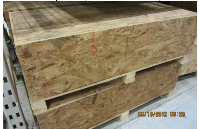
Exemple de design de type de caisse acceptable (structure en OSB)
